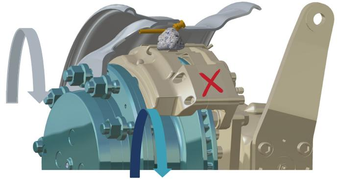
На осях с дисковыми тормозами тормозной диск и колесо вращаются с одинаковой скоростью, но тормозной суппорт неподвижен. При использовании колес с внутренним расположением вентиля с дисковыми тормозами существует высокий риск того, что камень или другие предметы могут повредить вентиль, застряв между тормозным суппортом и вращающимся ободом.
